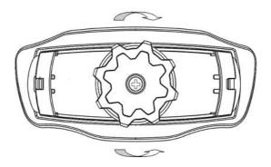
Ajuste la profundidad y ajuste a través de las bandas para optimizar la posición longitudinal de la cabeza a los ojos.
