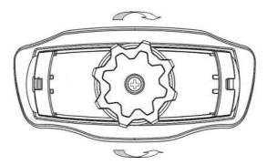
Régler la profondeur afin d'aligner parfaitement le bandeau avec le serre tête.
