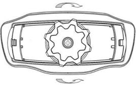
Stellen Sie die Tiefe ein und passen Sie sie mit Hilfe der Bänder an, um die Längsposition von Kopf bis Auge zu optimieren.
